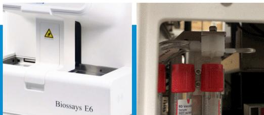
O método automático realiza medição anaeróbica para garantir a estabilidade dos níveis de cálcio ionizado e a precisão da medição.
