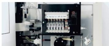
Módulo ISE - substituição de eletrodo tipo flip
